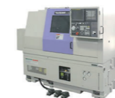
NC旋盤 TAKISAWA TC-200L6 【加工可能範囲】 最大加工外径φ300 最長加工 500L以内
